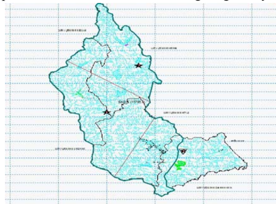
Hình 3. Chia lưu vực để tính trọng số trạm mưa theo phương pháp đa giác Thiessen.
